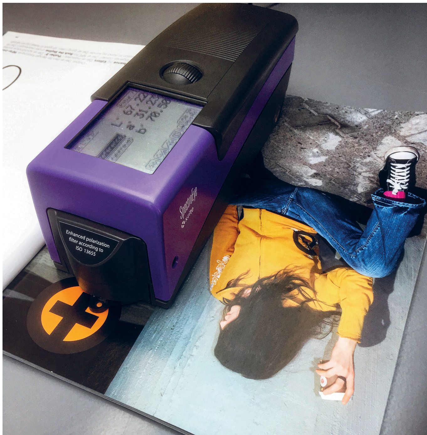
Opmåling af logoets orange farve, foretaget direkte på rastersammentrykket, hvor den ønskede farve er forsøgt gengivet. Her bliver farvestyring og ICC-profiler centrale.
